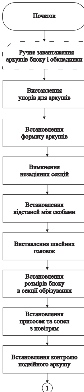
Рис. 4. Алгоритм налагодження до роботи і виготовлення рекламної продукції на комплектувально-швейно-фальцювально-різальній машині Heidelberg TB Sprint 315 (початок)
