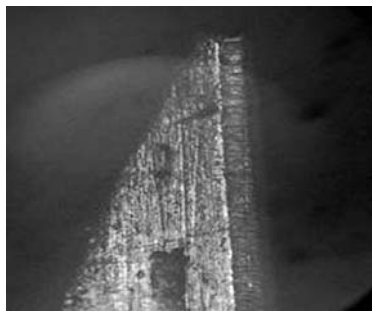
Рис. 1. Поверхня заплечика зі слідами механічної обробки поверхні (×50)
