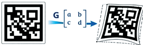
Рис. 4. Схема деформації бінарного AR-маркера під дією узагальної матриці перетворення G
