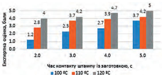
Рис. 13. Вплив часу контакту на чіткість границь відбитку залежно від температури на ручному пресі (зразок № 4)
