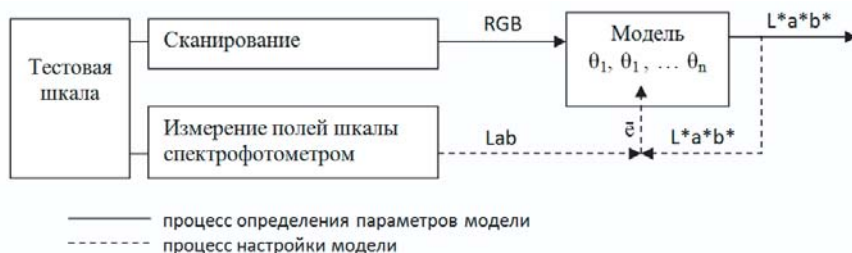
Рис. 1. Процесс преобразования цветowych координат
